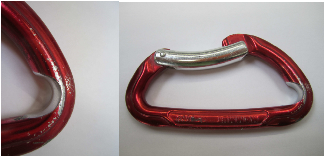
Abbildung 1: Karabiner mit Scharfkantenbildung durch Seilreibung.
