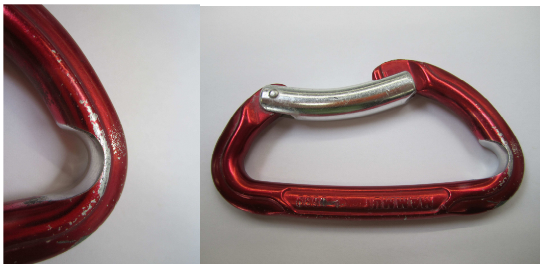
Illustration 1 : mousqueton avec formation d'une arête vive à cause du frottement de la corde.
