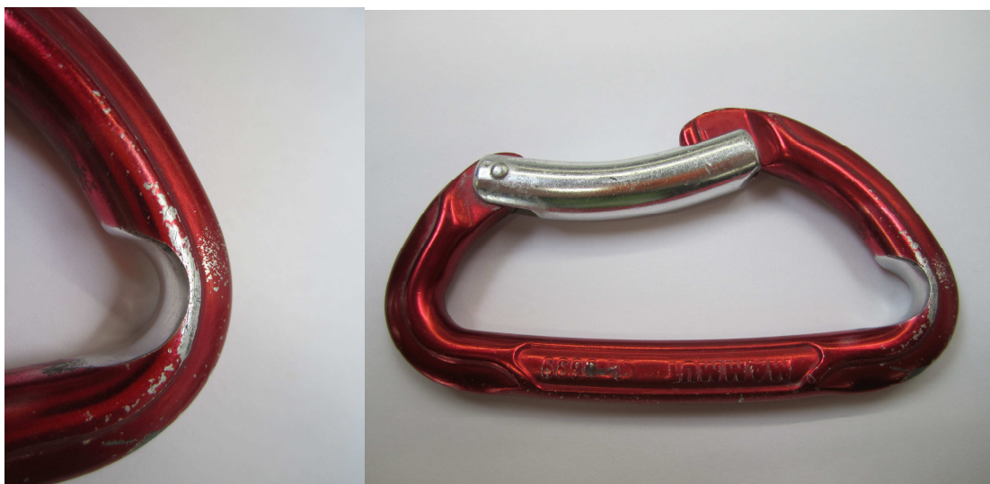
Figura 1: Mosquetón con formación de un canto afilado debido al rozamiento de las cuerdas.
